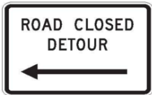
De straat is afgesloten. De pijl wijst in de richting van de omleiding.
